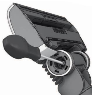
Odkręć oś i oczyść wszystkie części. Włożyć części z powrotem, wykonując czynności w odwrotnej kolejności.
