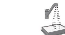
**Czyszczenie filtru wylotowego, który można oplukiwać wodą**
