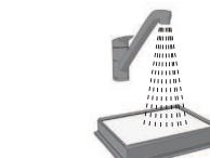
**Čištění omyvatelného výstupního filtru.** Opláchněte vnitřní (znečistěnou) stranu filtru vlažnou vodou. Poplejte na rám filtru, aby voda odtekla. Tento postup opakujte čtyřikrát.
