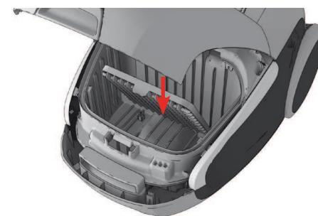
**Заменяйте фильтр двигателя при загрязнении или с каждым пятым пылесборником s-bag®.** Нажмите на держатель фильтра и выньте его. Замените фильтр и закройте крышку.
