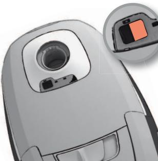
**Modeļi ar mehānisko indikatoru:** putekļu maiņš, s-bag®, jāmaina ne vēlāk kā tad, kad indikatora logs ir pilnīgi sarkans. Nolasiet indikatoru, kad uzgalis ir pacelts.
