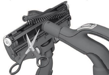
Wyjmij szczotkę rolkową i usuń zaplątane nitki i włókna, przecinając ją nożyczkami. Oczyść ssawkę, używając uchwytu węża. Włożyć części z powrotem, wykonując czynności w odwrotnej kolejności.
