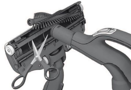
Vyměňte válcový kartáč a odstraněte namotané nitě. Hubici vyčistěte pomocí koncovky hadice. Vratte součásti na místo v obráceném pořadí.
