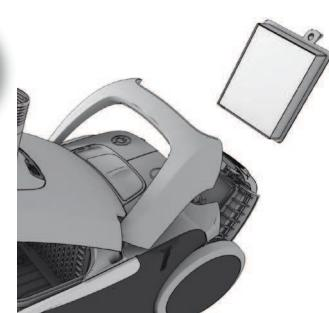
**Modeli z mehaničkim nadzorom moći sesanja:** Zamenjajte/očistite izhodni filter ob vsaki peti menjavi vrečke za prah s-bag®.
