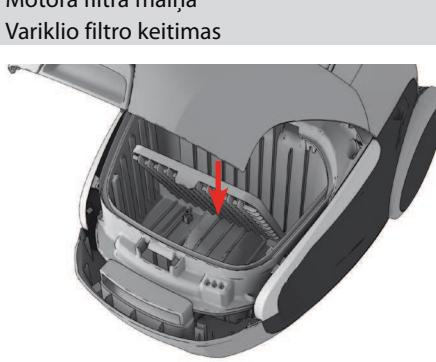
**Nomainiet motora filtru, kad tas ir netirs, vai pēc katra piektā s-bag®.** Nospiediet filtra turētāju uz leju un izvelciet to. Nomainiet filtru un aizveriet vāku.
