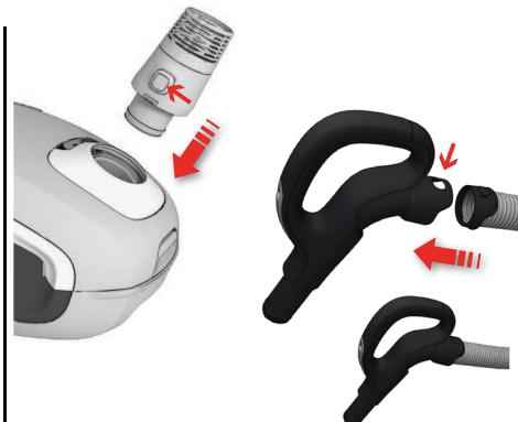
**Вставте шланг** (чтобы снять его, нажмите кнопки замка и вытяните).
