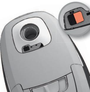
**Modeli z mehaničkim indikatorjem:** Vrečko za prah s-bag® morate zamenjati najkasneje, ko postane okence indikatorja v celoti rdeče. Odčitajte ga, ko je nastavek za sesanje dvignjen od tal.
