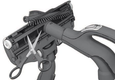
Vytiahnite čistiaci kotúč a nožnicami odstráhnite zachytené vlákna a nečistoty. Na vyčistenie hubice použite rukoväť hadice. Súčasti znova zložte v opačnom poradí.
