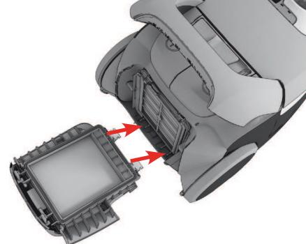
**Ak sa kryt filtra uvoľní**, upevnite ho nastavením dvoch pántov v spodnej časti a zatlačte kryt filtra späť, aby obe tlačidlá zapadli na miesto.
