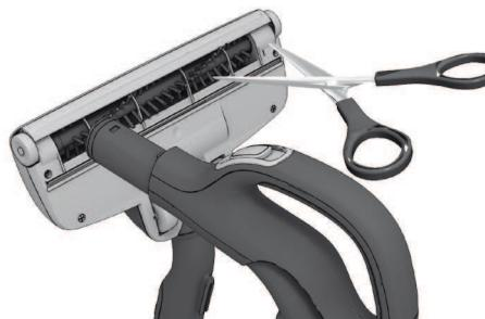
**Čiščenje mehanske turbo krtače (le določeni modeli)**
