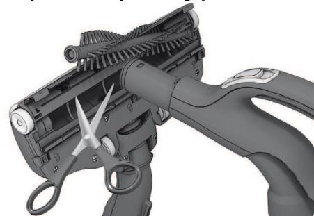
Izvelciet sukas rulliši un attīriet to no diegiem, izmantojot šķēres. Uzgaļa tīrišanai izmantojiet šķūtenes gofrētās caurules rokturi. Uzstādīet atpakaļ apgrieztā secībā.
