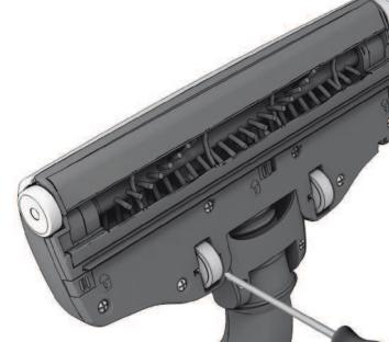
**Если колеса застяли,** осторожно снимите их небольшой отверткой.
