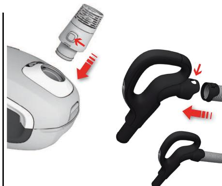
**Włóz wąż** (aby go wyjąć, naciśnij przyciski blokujące i wyciągnij wąż).
