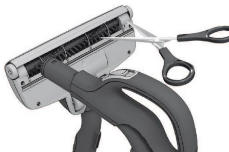
**Czyszczenie ssawki Turbo** (tylko niektóre modele)
