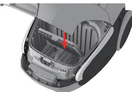
**Filter motorja zamenjajte, ko je umazan, ali po vsaki peti menjavi vrečke za prah s-bag®.** Nosilec filtra potisnite navzdol in ga izvlecite. Zamenjajte filter in zaprite pokrov.
