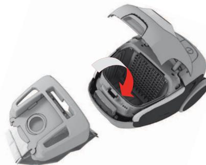
Umieść wkładkę podtrzymującą worek w komorze worka i zamknij pokrywę.
