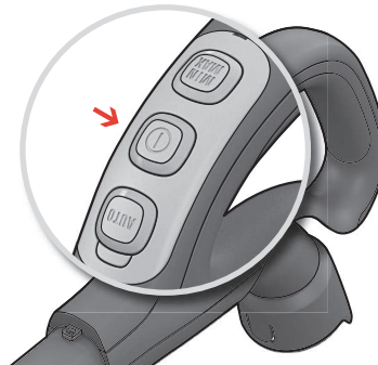
8. Modely s diaľkovým ovládaním možno ovládať aj VYPÍNAČOM na rukoväti.
