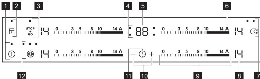
Pentru a utiliza aparatul folosiți câmpurile cu senzori. Afisajele, indicatoarele și semnalele sonore indică funcțiile active.
