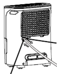
Fiksirajte crevo za odvod kondenzata
