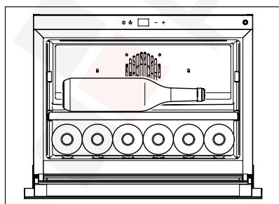
Pro usnadnění skladování širokých a vysokých láhví na druhé polici lze vyjmout horní polici v souladu s uvedeným obrázkem.
