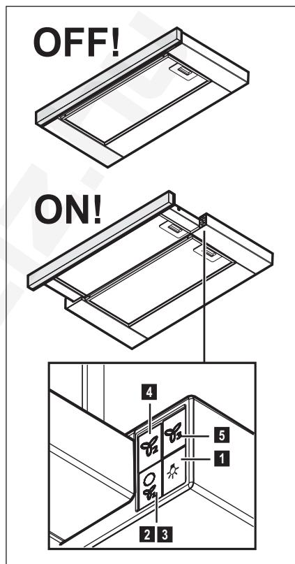
1. Вклучување/Исклучување на светлото
