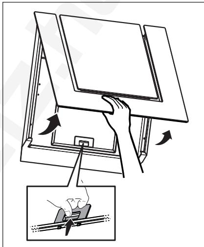
**4.2 Der NICHT waschbare Aktivkohlefilter** - Je nach der Benutzungsdauer des Herdes und der Häufigkeit der Reinigung des Fettfilters tritt nach einer mehr oder weniger langen Benutzungsdauer die Sättigung des **Aktivkohlefilters** auf. Auf jeden Fall muß der Filtereinsatz mindestens alle 4 Monate ausgewechselt werden. Er kann NICHT gereinigt oder erneut aktiviert werden.
