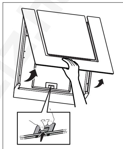
**4.2 НЕ моющий угольный фильтр** Насыщение угольного фильтра происходит по истечении более или менее длительного периода эксплуатации, предопределенного типом кухни и периодичностью задержки жира. В любом случае, заменяйте патрон по крайней мере через каждые 4 месяца. Угольный фильтр НЕ подлежит мойке или регенерации.
