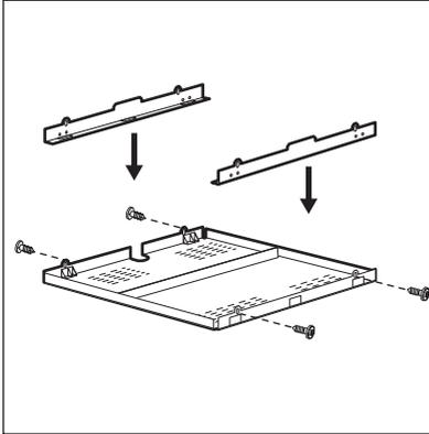
Po zamontowaniu kasetki ochronnej (wyposażenie dodatkowe), nie ma konieczności pozostawienia 2 mm przestrzeni wentylacyjnej z przodu, jak i montażu przegrody zabezpieczającej bezpośrednio pod płytą grzejącą. Wyposażenie dodatkowe w postaci kasetki ochronnej może być niedostępne w niektórych krajach. W celu uzyskania dodatkowych informacji należy skontaktować się z miejscowym dostawcą.
