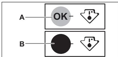
**i** Friss élelmiszer behelyezése vagy a készülék ajtajának hosszabb ideig tartó vagy többszöri kinyitása után normális jelenség, hogy az OK üzenet eltűnik a kijelzőről; várjon legalább 12 órát a hőmérséklet-szabályozó újraillesztésével.
