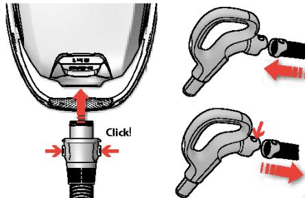
**2. Csatlakoztassa a tömlöt a készülékhez** (eltávolításához nyomja meg a rögzítőgombokat, majd húzza ki a gégecsövet).
