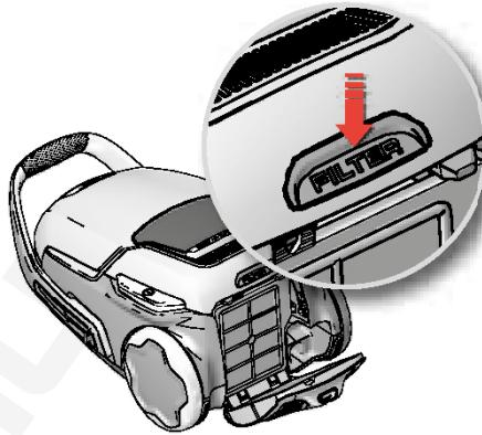
**3. Отворете капака на филтъра, като натиснете бутона ФИЛТЪР в задната част на уреда за почистване.** Използвайте оригинални филтри на Electrolux; EFS 1W / EFH 12W.
