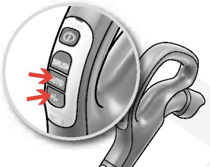
**10. Podesite usisnu snagu.** Modeli s daljinskim upravljanjem. Rad započinje u automatskoj funkciji (automatsko upravljanje snagom). Za ručno namještanje pritisnite gumb “-” (najmanje) ili gumb “+” (najviše). Za povratak na automatsku funkciju pritisnite gumb AUTO.
