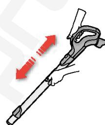
**5. Nastavte teleskopickou trubici** – jednou rukou podržte zámek a druhou zatáhněte za rukojet.
