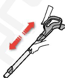
5. Регулирайте телескопичната тръба като с едната си ръка държите натиснат бутона за заключване, докато изтегляте дръжката с другата си ръка.
