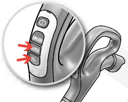
**10. Отрегулируйте мощность всасывания. Модели с дистанционным управлением.** Пылесос запускается в авторежиме (автоматическое управление мощностью). Для ручной регулировки нажмите кнопку “-” (минимум) или кнопку “+” (максимум). Для возврата в авторежим нажмите кнопку AUTO.
