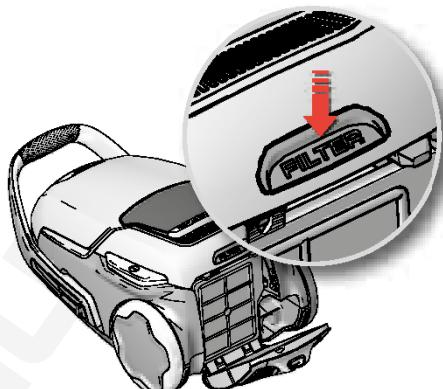
**3. Откройте крышку фильтра нажатием кнопки «FILTER» на задней части пылесоса.** Используйте оригинальные фильтры Electrolux EFS 1W / EFH 12W.
