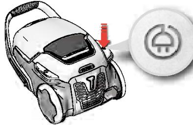
**10.** Emme gücünü ayarlayın. Uzaktan kumandalı modeller. Elektrik süpürgesi otomatik modda çalışmaya başlar (Otomatik güz ayarı). Manuel ayarlamak için "—" düğmesi (minimum) veya "+" düğmesine (maksimum) basın. Otomatik moda geri dönmek için tekrar AUTO düğmesine basın.
