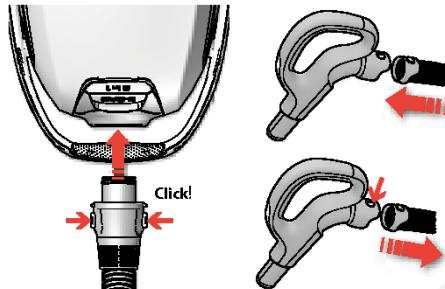
**2. Umetnите cijev u usisavač (da biste ga uklonili, pritisnite gumb za zaključavanje i izvucite ga). Gurnite crijevo u ručku crijeva sve dok zapori ne dođu na svoje mjesto.**
