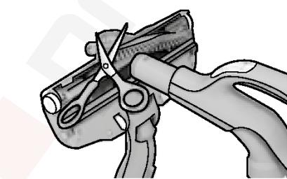
2. Izvucite valjak s četkom i uklonite zapletene nitи režući ih škarama. Za čišćenje sapnice upotrijebite ručku crijeva. Sastavite obratnim redoslijedom.
