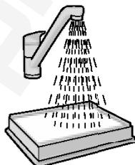
**5. Čišćenje perivog ispušnog filtra** Operite samo unutar nju (prijavu) stran u tekućoj mlačoj vodi. Stresite okvir filtra da biste uklonili vodu. Postupak ponovite četiri puta.
