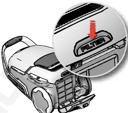
**1. SZÜRŐ visszajelzővel ellátott modellek (+/- kijelző és távvezérlős modellek).** Amikor a "szűrő" visszajelző világít, cserélje ki/tisztítsa meg\* a szűrőt. \*csak a mosható szűrők esetén
