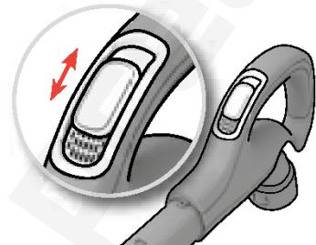
W modelach ze sterowaniem ręcznym zawór powietrzny może pomóc szybko zmniejszyć siłę ssania.
