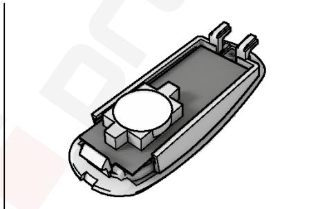
**2. Používejte pouze baterie typu LITHIUM CR1632.** Baterie je nutné pred vyťažením prístroja vytiahnuť a bezpečným zpôsobom zlikvidovať.
