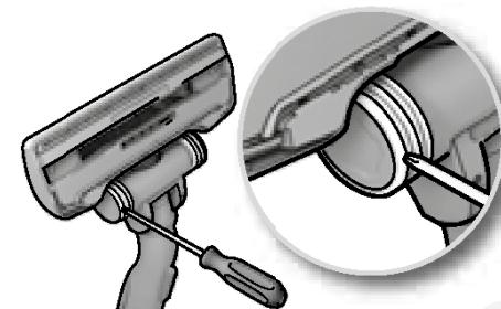
2. **Если колеса застревают,** очистите их, сняв крышки небольшой отверткой.
