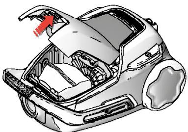
**1.** Otevřete kryt prachového oddílu zatažením za tlačítko uvolnění sáčku „S-BAG“. **Zkontrolujte, že sáček s-bag® na svém místě.**
