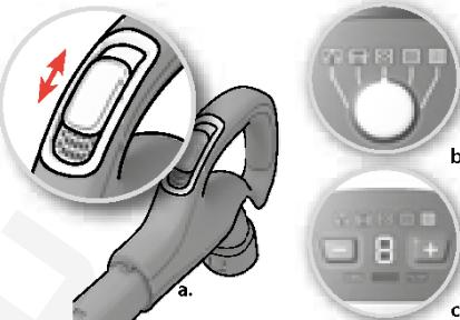
**9. Отрегулируйте мощность всасывания.** Модели с ручной регулировкой. а) Для быстрого ослабления воздушного потока воспользуйтесь воздушным клапаном на рукоятке. б) Воспользуйтесь поворотной ручкой на пылесосе для регулировки мощности всасывания. в) Воспользуйтесь кнопками «+/-» для регулировки мощности всасывания.
