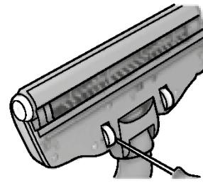
3. В случае заклинивания колесиков осторожно выньте их при помощи небольшой отвертки и произведите очистку.
