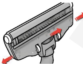
1. Otvorite poklopac valjka s četkom pritiskom na spojnice. Tako ćete oslobođiti prednje kotačiće za čišćenje.
