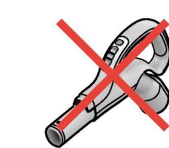
**⚠️ A távvezérlős fogantyúval és motoros szívőfejjel ellátott modell NEM rendelkezik elemmel vagy visszajelzővel. NE próbálja meg kinyitni a motoros fogantyút.**
