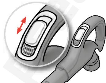
Na modelima s ručnim upravljanjem ventil za zrak može pomoći u brzom smanjivanju snage usisa.
