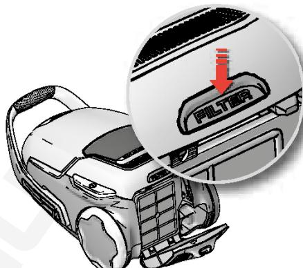
**3. Otwórz pokrywę filtra, naciśkając przycisk FILTER (filtr) z tyłu odkurzacza.** Używaj oryginalnych filtrów Electrolux; EFS 1W / EFH 12W.
