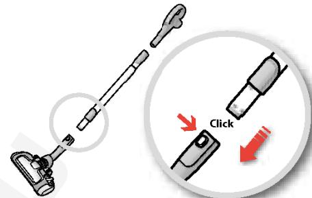
**3. Приедините телескопическую трубку к насадке для пола** (чтобы снять ее, нажмите кнопку замка и снимите насадку).
