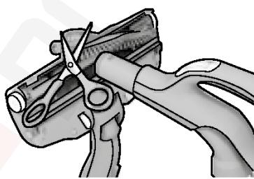
**2.** Húzza ki a forgókefét, és ollóval távolítsa el a rácavarodott szálakat. A szívófej megtisztításához használja a gégecső fogantyúját. Az összeszereléshez végezze el a fenti műveleteket fordított sorrendben.
