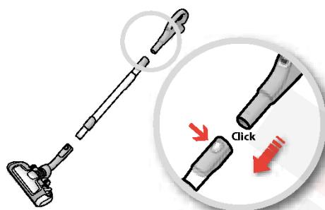
**4. Podłącz rurę teleskopową do uchwytu węża (aby ją odłączyć, naciśnij przycisk blokujący i wyciągnij uchwyt węża).**
