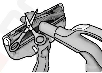
2. Vyjměte válcový kartáč a odstráhněte namotané nitě. Hubici vyčistěte pomocí koncovky hadice. Vratěte součásti na místo v obráceném pořadí.
