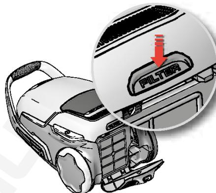
3. لفتح خزان الفلتر فـ بالضغط على زر FILTER أسبق المكنسة. يرجى استخدام فلاتر Electrolux الأصلية: EFS 1W / EFH 12W.
