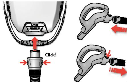
**2. Вставьте шланг в пылесос** (чтобы снять его, нажмите кнопки замка и вытяните шланг).
