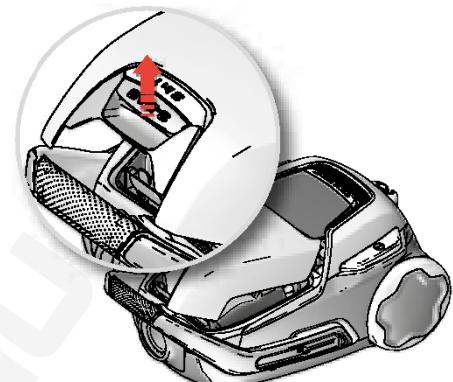
**3. Otwórz pokrywę komory worka na kurz, pociągając prycisk S-BAG.**
