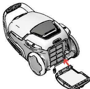
**7.** В случае ослабления фиксации крышки фильтра заново установите её, поместив крышку стороной с крюками в соответствующие пазы, затем нажмите на крышку до фиксации на месте со щелчком.
