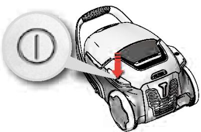
**7. Pokrenite/zaustavite usisivač pritiskom na gumb UKLJ./ISKLJ.**
