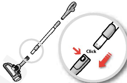
**3. Csatlakoztassa a teleszkópos csövet a szívófejhez** (eltávolításához nyomja meg a rögzítőgombot, majd húzza ki a szívófejet).
