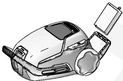
**4. Wyciągnij filtr i sprawdź typ filtru na podstawie koloru ramki.** Zielony: wymaga wymiany na nowy filtr. Niebieski: wymaga wymiany na nowy filtr lub wyczyszczenia, patrz punkt 5 (filtr przeznaczony do mycia).
