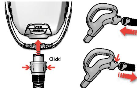
**2. Podłącz wąż do odkurzacza (aby go odłączyć, naciśnij przyciski blokujące i wyciągnij wąż).**
