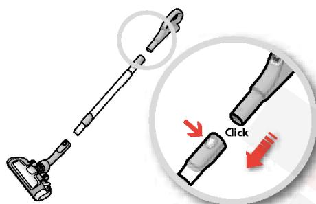
**4. Приедините телескопическую трубку к рукоятке шланга** (чтобы снять ее, нажмите кнопку замка и вытяните рукоятку шланга).
