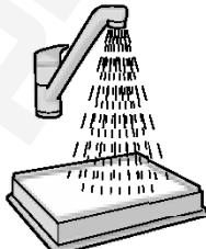
**5. Czyszczenie filtru wyłosowanego, który można oplukiwać wodą.** Wewnętrzna (brudna) stronę filtru należy oplukać pod kranem letnią wodą. Postukaj ramkę filtru, aby usunąć z niego wodę. Powtórz ten proces cztery razy.
