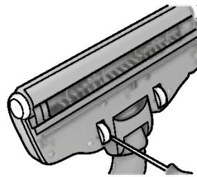
3. Ako se zaglavaju kotači, pažljivo ih odstranite pomoću malog odvijača i očistite kotače.
