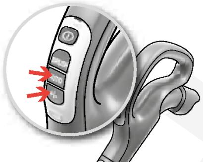
**10.** Регулиране на силата на засмукване. Модели с дистанционно управление. При включване, прахосмукачката започва работа в автоматичен режим (автоматично регулиране на мощността). За да регулирате ръчно, натиснете бутона "—" (минимум) или бутона "+" (максимум). За да се върнете в автоматичен режим, натиснете бутона AUTO.
