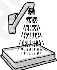
**5. Čištění omyvatelného výstupního filtru.** Opláchněte vnější (znečištěnou) stranu filtru vlažnou vodou. Poklepejte na rám filtru, aby voda odtekla. Tento postup opakujte čtyřikrát.
