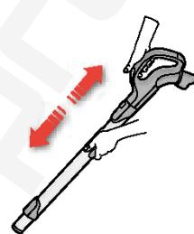
**5. Namjestite teleskopsku cijev tako što ćete jednom rukom držati gumb za zaključavanje, a drugom izvući ručku.**
