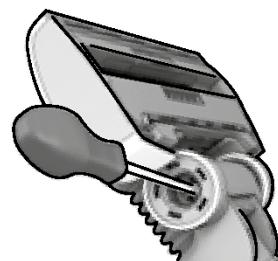
**3.** Csavarozza ki a keréktengelyt, és tisztítsen meg minden alkatrészt. Az összeszereléshez végezze el a fenti műveleteket fordított sorrendben.
