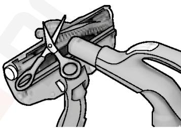
2. Wyjmij szczotkę rolkową i usuń zaplątane nitki i włókna, przecinając je nożyczkami. Oczyść ssawkę, używając uchwytu węza. Włóz części z powrotem, wykonując te czynności w odwrotnej kolejności.
