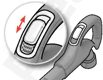
На моделях с ручным управлением воздушный клапан позволяет быстро снизить мощность всасывания.
