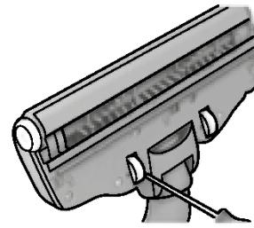
1. Stlačte uvolňovacie tlačidlo a otvorte kryt čistiaceho kotúča. Tým sa uvoľnia predné kolieska na čistenie.
