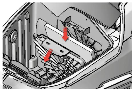
8. Zamijenite filter motora kad se zaprlja ili nakon svake pete zamjene vrećice s-bag®. Gurnite držač filtra prema dolje i izvucite ga. Zamijenite filter i zatvorite poklopac.
