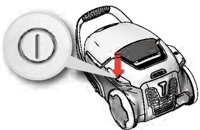
**7. Vysavač zapněte nebo vypněte** stisknutím tlačítka ZAPNOUT/VYPNOUT.
