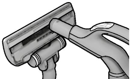
1. Skinite sapnicu s cijevi. Za čišćenje sapnice upotrijebite ručku crijeva.
