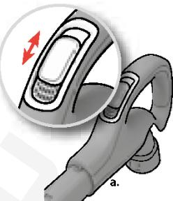
**9. Wyreguluj siłę ssania.** Modele z ręczną regulacją. a) Użyj regulacji ssania na uchwycie, aby szybko zredukować przepływ powietrza, b) Użyj pokrętła na odkurzaczu, aby ustawić siłę ssania, c) Użyj przycisku + lub - na odkurzaczu, aby ustawić siłę ssania.
