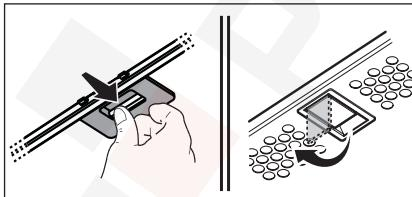
**4.2 150型长寿命 - 可清洗的碳材料过滤网**可用温水和适当的洗洁剂每二个月清洗一次，或用洗餐具机以65度水温清洗（如果用餐具机清洗，需要在没有餐具的情况下单独清洗）。在不损坏过滤网的情况下，将多余的水份去掉，然后拿下放在塑料框内部的垫子，将烤箱调到100度，放入十分钟，这样会完全烘干。每三年更换一次垫子，如果垫子有损，需随时更换。
