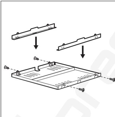
Če uporabljate zaščitno omarico (dodatna oprema), dvomilimetrski reža za pretok zraka spredaj in zaščitno dno pod kuhalno ploščo nista potrebna. Zaščitna omarica morda ne bo na voljo v nekaterih državah. Obrnite se na krajevnega dobavitelja.
