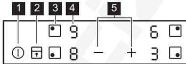
Folosii câmpurile cu senzori pentru controlul aparatului. Afișajele, indicatoarele și semnalele sonore indică funcțiile active.
