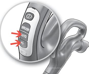
**10. Állítsa be a szívőteljesítményt (távirányított típusoknál).** A porszívó az automata funkcióval (automatikus teljesítmény-szabályzás) indul el. A kézi szabályozáshoz nyomja meg a „-“ (minimum) vagy „+“ (maximum) gombot. Az automata funkcióhoz az AUTO gomb megnyomásával térhet vissza.
