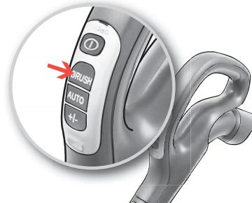
**11. Távirányítású, Aeropro motoros szívőfejjel rendelkező típusok.** A motoros szívőfej bekapszolásához nyomja meg a BRUSH (kefe) gombot a fogantyún.
