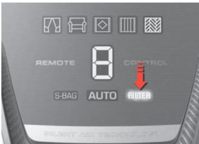
**1. SZŰRŐ visszajelzővel ellátott modellek** (+/- kijelző és távvezérlős modellek). Amikor a "szűrő" visszajelző világít, cserélje ki/tisztítsa meg\* a HEPA szűröt. \*csak a mosható szűrök esetén
