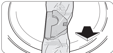
3. Retire o tubo de folha de alumínio e o calço de poliestireno da máquina.
