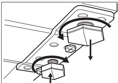
Встановлюючи прилад, подбайте про те, щоб він стояв рівно. Цього можна досягти за допомогою двох регульованих ніжок, що розташовані спереду вниз.
