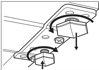
Urządzenie należy właściwie wypoziomować podczas ustawiania. Służą do tego dwie regulowane nóżki z przodu urządzenia.
