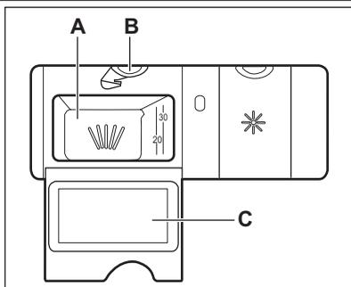
1. Nyomja meg a kioldó gombot (B) a fedél (C) felnyitásához.
