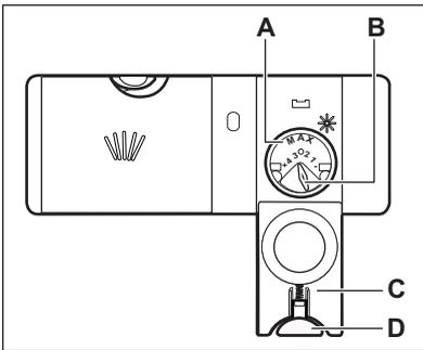
1. Nyomja meg a kioldó gombot (D) a fedél (C) felnyitására.
