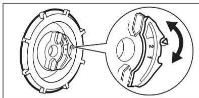
Coloque el selector de dureza del agua en la posición 1 o 2.
