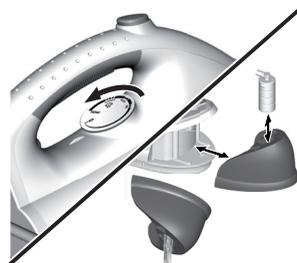
6. Ustawić pokrętkę wyboru temperatury na minimalną wartość. Następnie wyłączyć żelazko z wytwornicą pary i odłączyć je od źródła zasilania. **Opróżnić zbiornik na wodę** i przed schowaniem żelazka odczekać aż żelazko całkowicie ostygnie.
