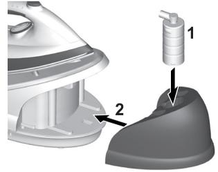
**6. Vložte zásobník na vodu zpět** do stanice. Ujistěte se, že jsou západky zásobníku na vodu bezpečně zajištěné ve svém místě.
