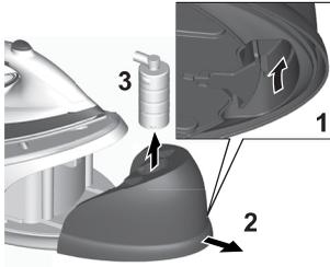
**1. Rimuovere il serbatoio dell'acqua** afferrando la fessura sul retro e tirandola gentilmente dall'unit  di base. Tenere il serbatoio dell'acqua in posizione sicura mentre si sostituisce la cartuccia anticalcare.
