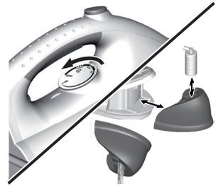
**6. Impostare nuovamente il selettore della temperatura** sull'impostazione minima. Spegnerne, quindi, il ferro da stiro con generatore di vapore e scollegarlo dalla presa di corrente. **Svuotare il serbatoio dell'acqua** e consentire al ferro di raffreddarsi completamente prima di riporlo.
