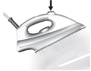
3. **Per attivare il vapore**, premere il pulsante del vapore. Quando si rilascia il pulsante, utilizzare il vapore prima di rimetterlo a posto sulla stazione ferro a vapore.
