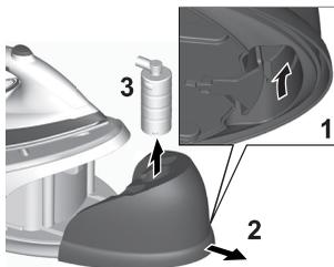
**2. Izņemiet ūdens rezervuāru,** satverot iedobi tā apakšpusē un uzmanīgi izvelkot to no pamatbloka.
