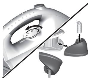
**6. Pagrieziet temperatūras regulatoru** atpakaļ uz minimālo iestatījumu. Pēc tam izsēdziet gludekli ar tvaika ģeneratoru un atvienojiet to no elektroapgādes tīkla. Iztukšojiet ūdens rezervuāru un ļaujiet gludeklim pilnībā atdzist, pirms noglabāt to.
