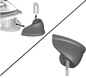
**I** 4. **Lasciare sempre raffreddare il ferro** completamente sul piano di riposo prima di riporlo. Una volta che il ferro si è raffreddato, svuotare il serbatoio dell'acqua. Riporre il ferro da stiro con generatore di vapore.
