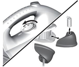
6. **Otočte volič teploty** zpátky na minimální nastavení. Poté žehličku s parním generátorem vypněte a vypojte ji ze sítě. **Vyprázdněte zásobník na vodu** a před uložením nechte žehličku zcela vychladnout.
