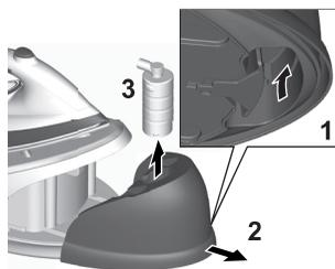
**1. Scoateți rezervorul de apă** prinzând de fanta de pe partea inferioară și trăgându-l ușor din unitatea de bază. Păstrați rezervorul de apă într-un loc sigur, în timp ce înlocuiți cartușul anti-calcar.
